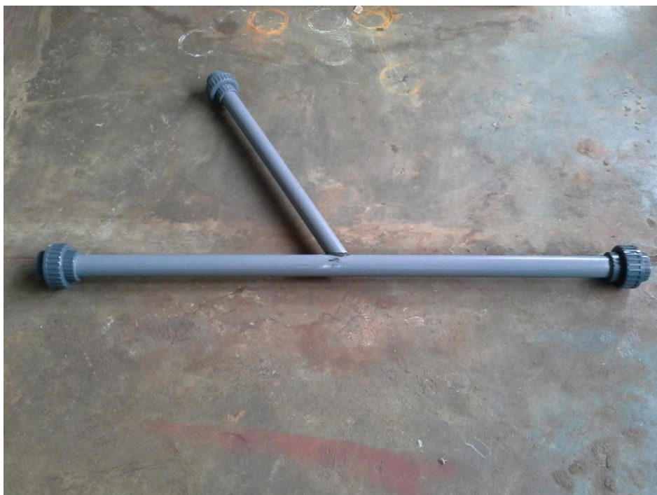
Gambar 4 sesi uji pipa cabang 31,8mm
