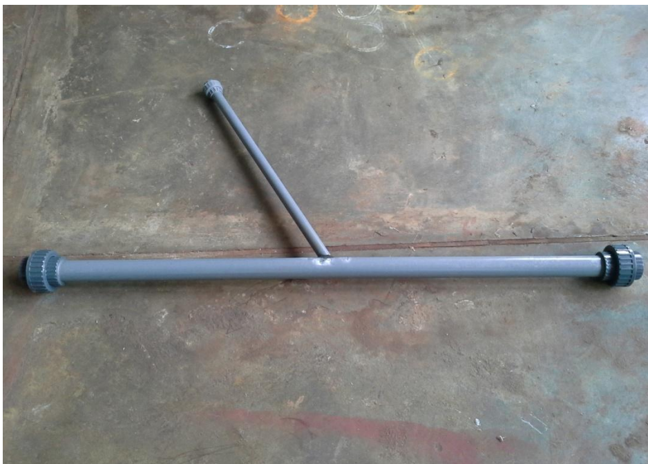
Gambar 2 Sesi uji pipa cabang 19,1mm
