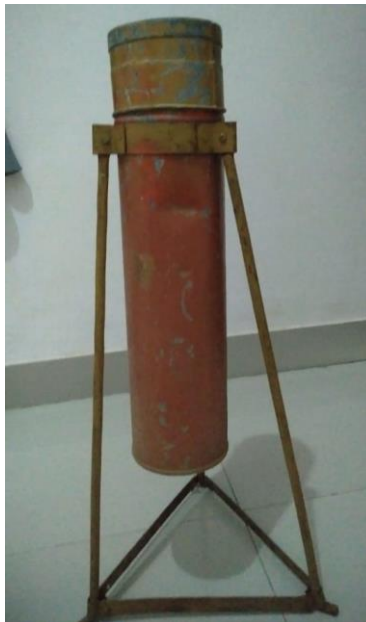
Gambar 1. Penakar Curah Hujan Tipe Observatorium
