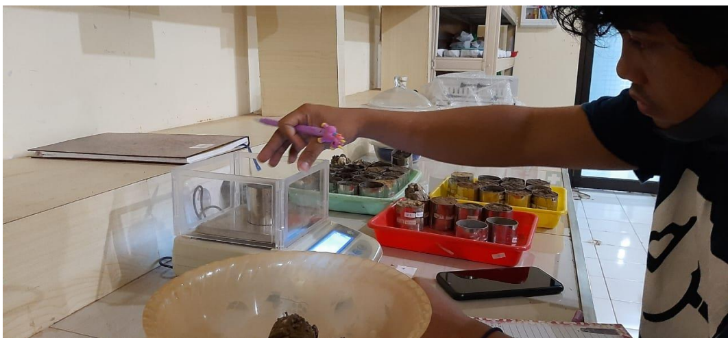
Menimbang Hasil Oven Untuk Penentuan Bulk Density dan Porositas Tanah
