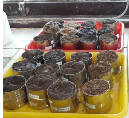
Proses Perendaman Sampel Tanah yang Sudah di Oven
