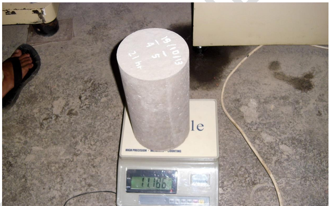
Gambar 30. Penimbangan berat sampel benda uji
