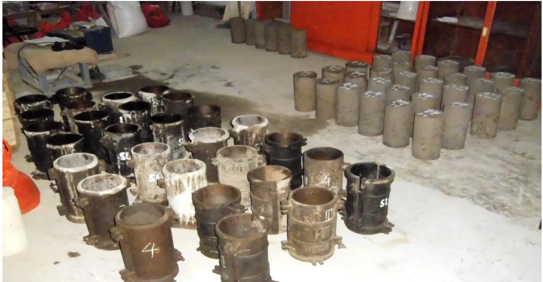
Gambar 23. Sampel Slinder beton yang telah dibuat dari semen pcc
