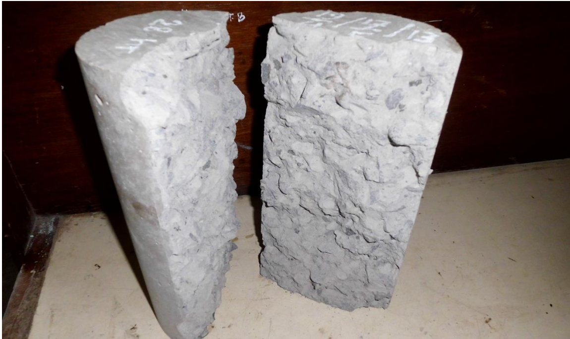
Pada gambar 36 Hasil uji tarik slinder beton dengan biotek semen pada umur beton hari ke dua puluh delapan.
