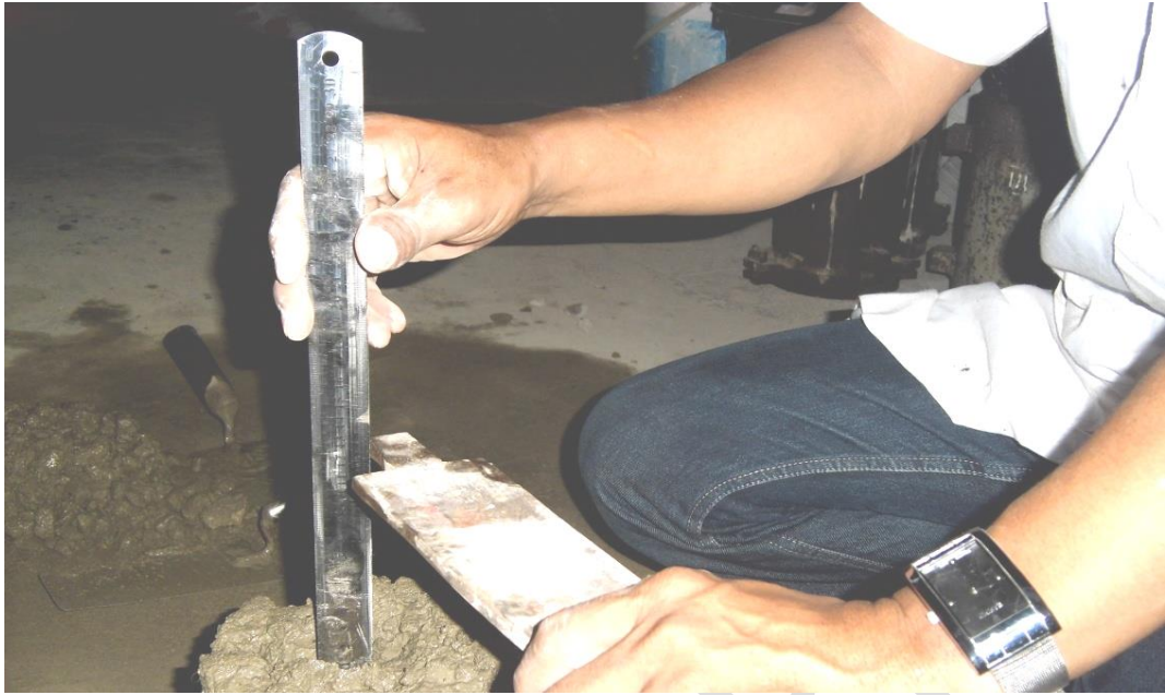
Gambar 25 Proses pengukuran slump beton untuk sampel benda uji
