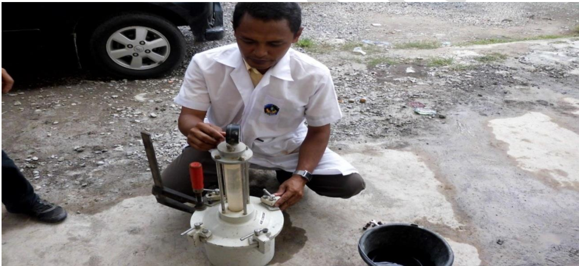
Gambar 41. Tampak peneliti sedang melakukan pengukuran prosentase kandungan udara beton segar
