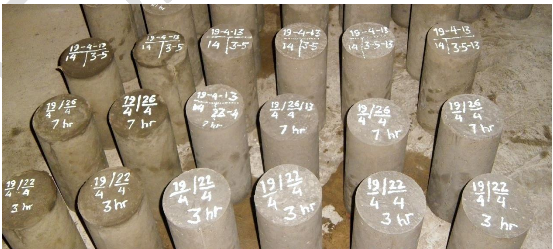
Gambar 22. Sampel Slinder beton yang telah dibuat dari biotek semen
