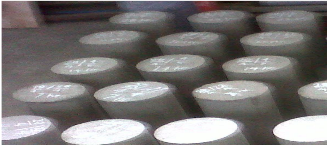
Gambar 28. Tampak perawatan dengan metode dry curing pada sampel benda uji biotek semen
