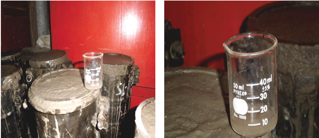
Gambar 38. Kandungan air bleeding benda uji yang telah dimasukkan kedalam gelas ukur.
