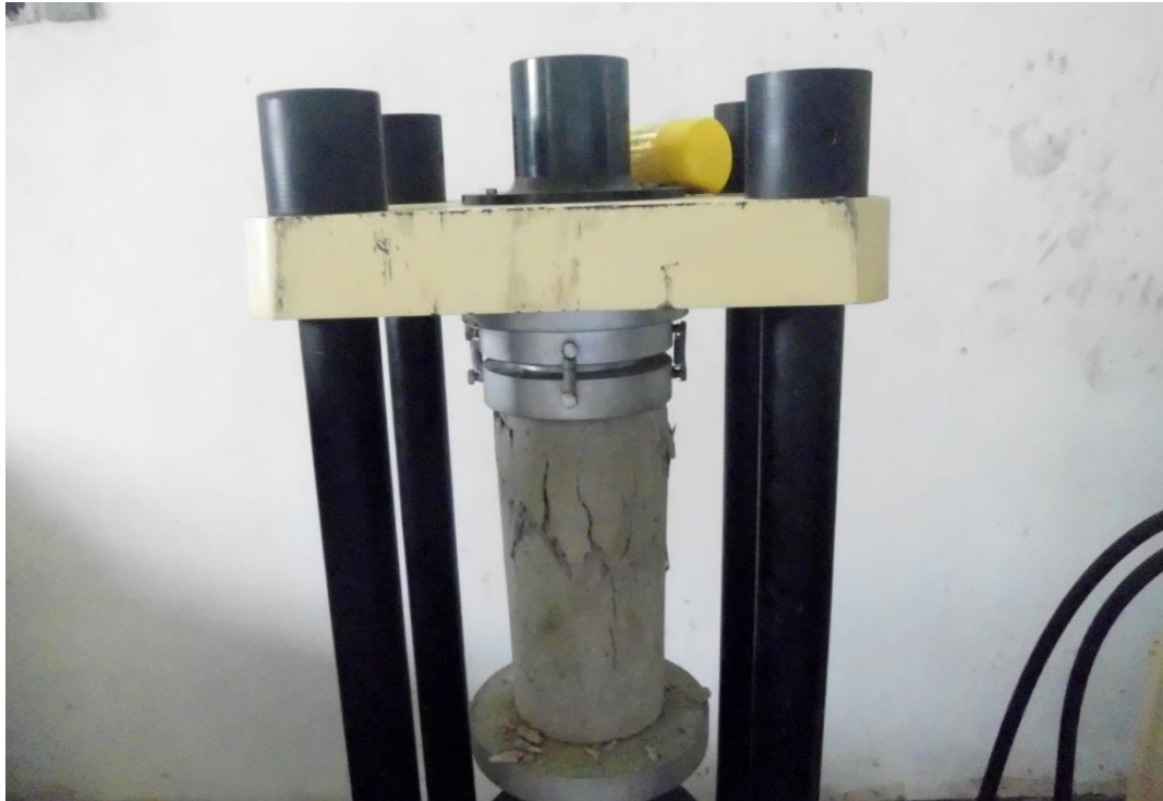
Gambar 33. Tampak retakan beton dengan sampel benda uji biotek semen setelah ditekan dengan mesin uji tekan.
