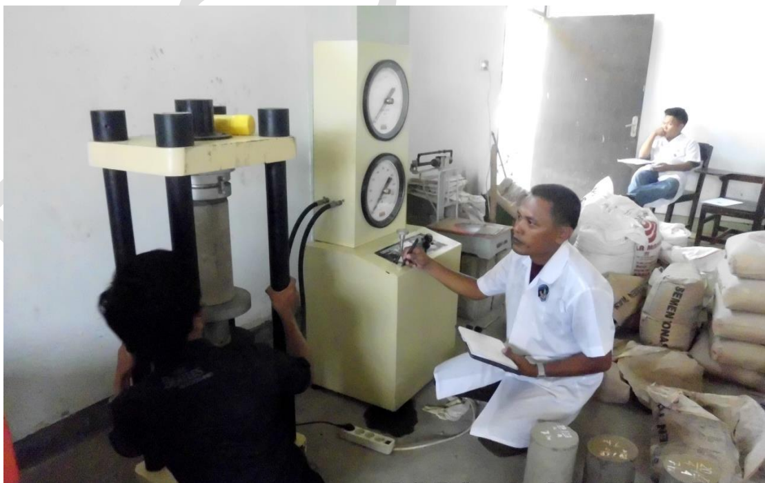
Gambar 32. Tampak peneliti sedang menjalankan mesin tekan beton dengan sampel benda uji biotek semen.
