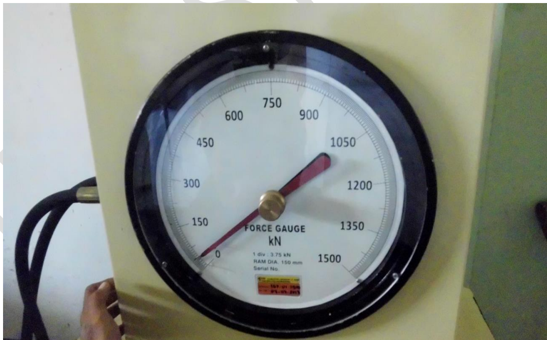
Gambar 34. Tampak jarum mesin uji tekan beton menunjukkan angka 30,75 kN dengan sampel benda uji biotek semen pada umur beton hari ke tiga.
