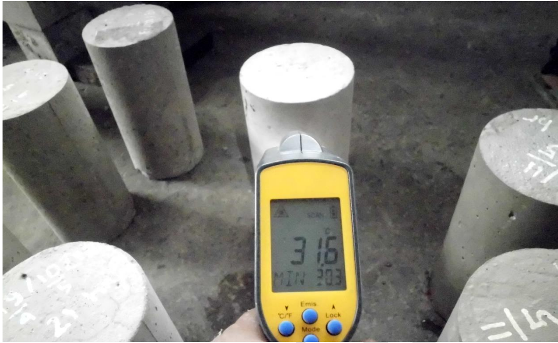
Gambar 31. Pengukuran suhu sampel benda uji
