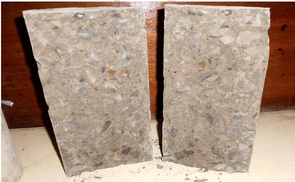
Pada gambar 36 Hasil uji tarik slinder beton dengan biotek semen pada umur beton hari ke dua puluh delapan.
