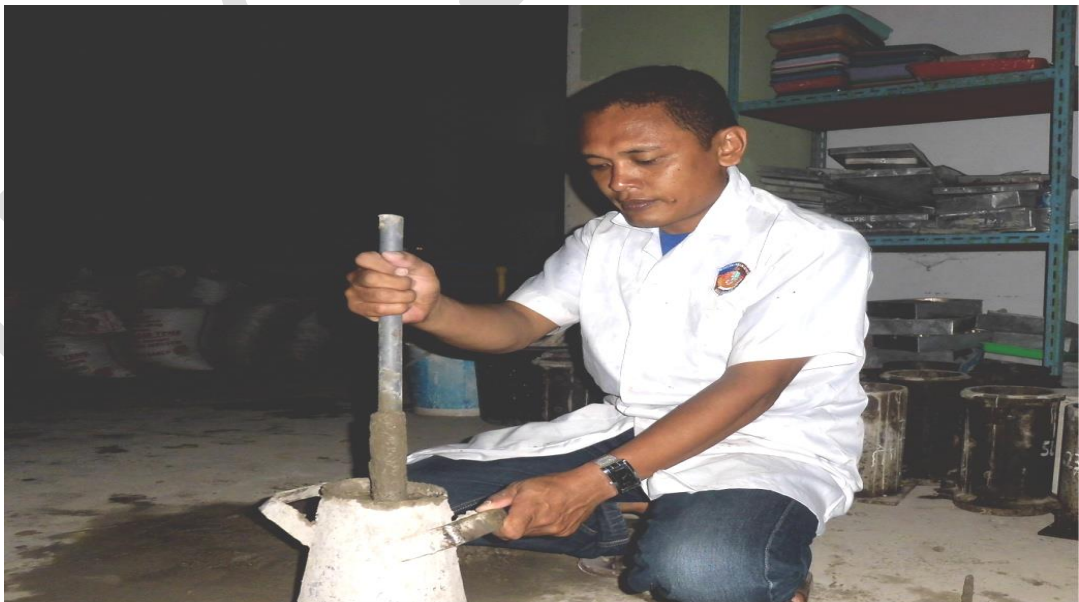
Gambar 24 Proses pembuatan slump beton untuk sampel benda uji
