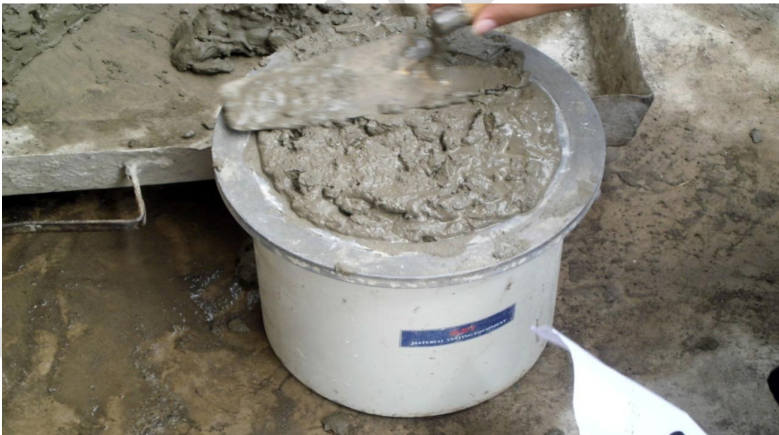
Gambar 39 Berikut ini memperlihatkan proses pengisian adukan beton segar kedalam alat pengukuran prosentase kandungan udara.
