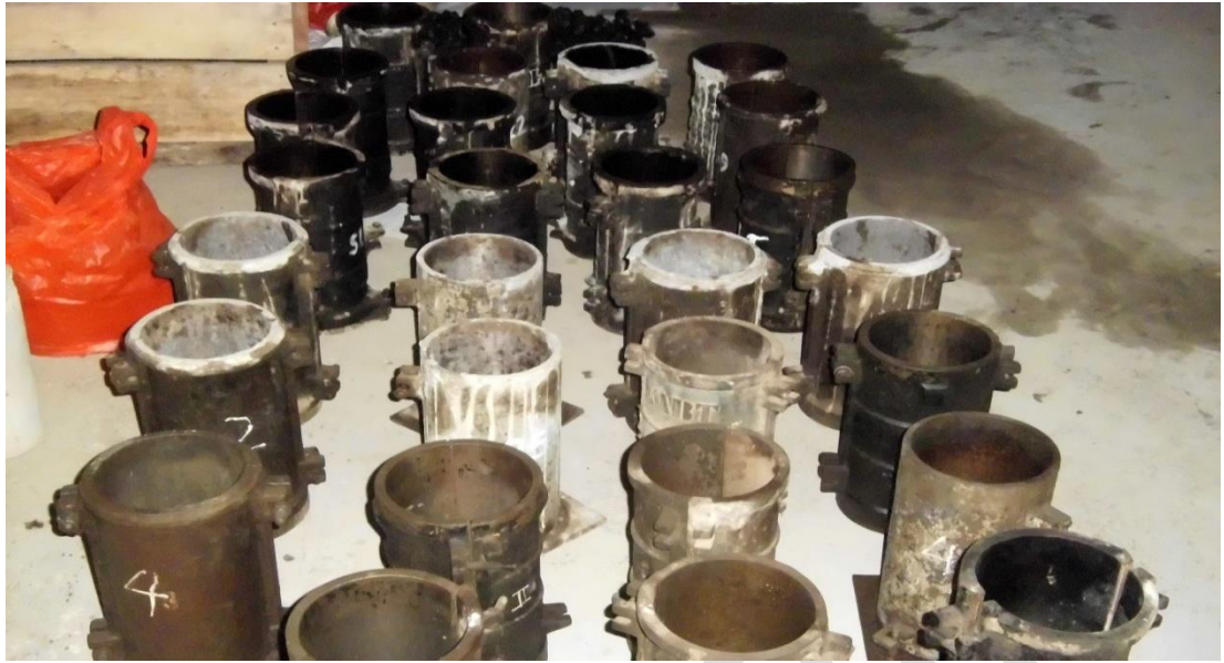
Gamba 21 Bekisting Slinder beton telah dipersiapkan.
