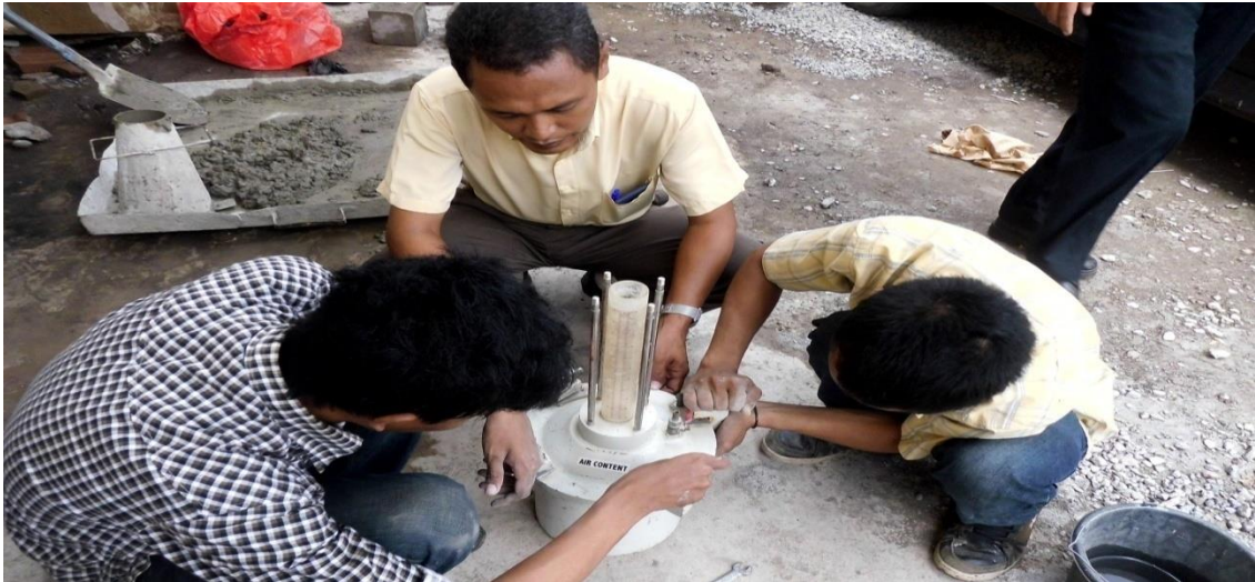
Gambar 40. Tampak peneliti sedang memasang penutup alat pengukuran prosentase kandungan udara.
