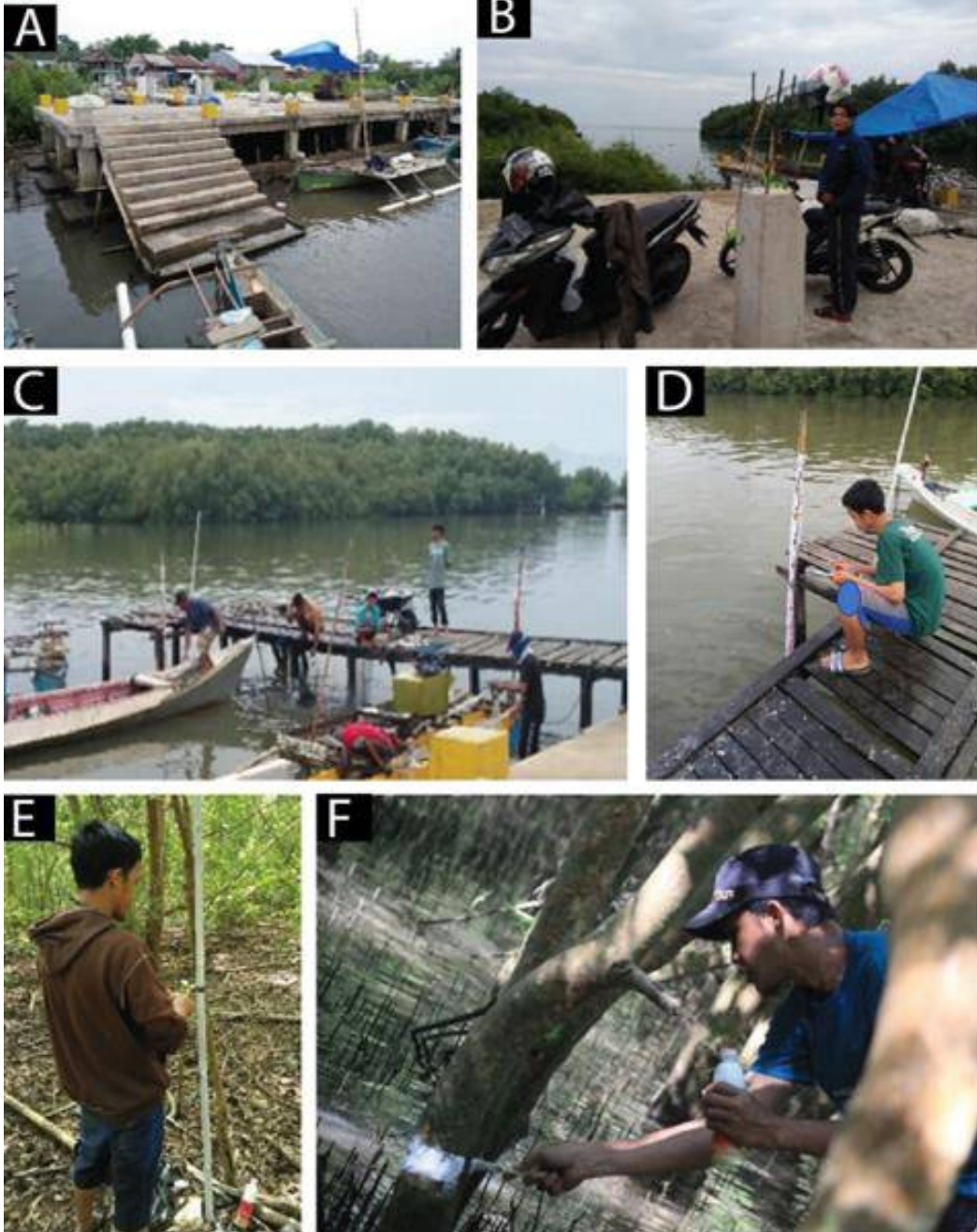
Gambar 66. Pengambilan data pasang surut : (a) Dermaga pendaratan ikan; (b) Persiapan mengambil data pasang surut pada rambu pasang; (c) Memasang rambu pasang; (d) Mengambil ketinggian pasang pada rambu pasang; (e) memasang patok penanda pengambilan data pasang tertinggi tiap Stasiun; (f) Menandai pasang tertinggi pada Stasiun
