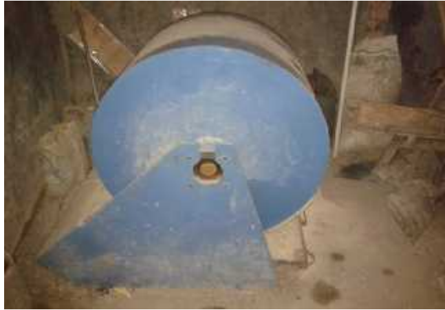
Pengujian keausan agregat kasar dengan mesin loss angles
