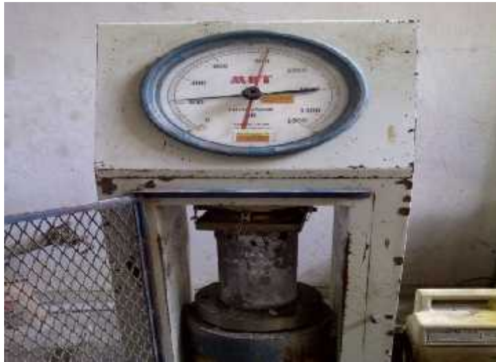
Pengujian Kuat Tekan Beton umur 28 hari
