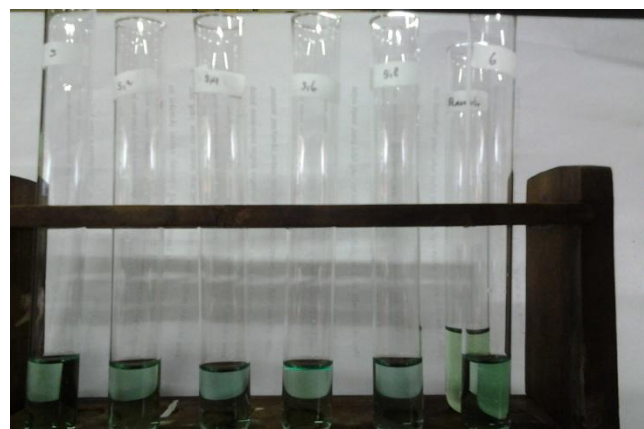
Penentuan kadar glukosa (hasil hidrolisis + reagen Nelson + arsenomolibdar + H 2 O)
